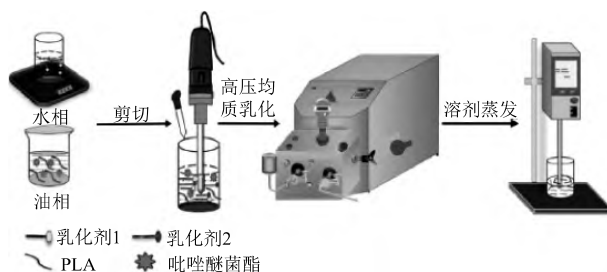
图1 高压均质乳化技术和乳化溶剂蒸发法制备吡唑醚菌酯纳米微球示意图
