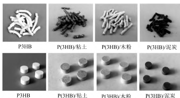
图3 PHB分别与粘土、木粉、泥炭混合挤压制备的噁菌酯微丸和颗粒
