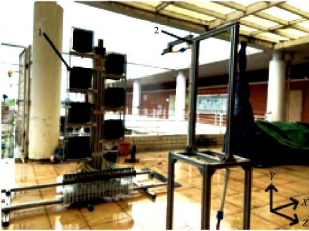
图6 雾滴飘移补偿试验
