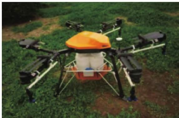
图5 无人机载静电施药系统
