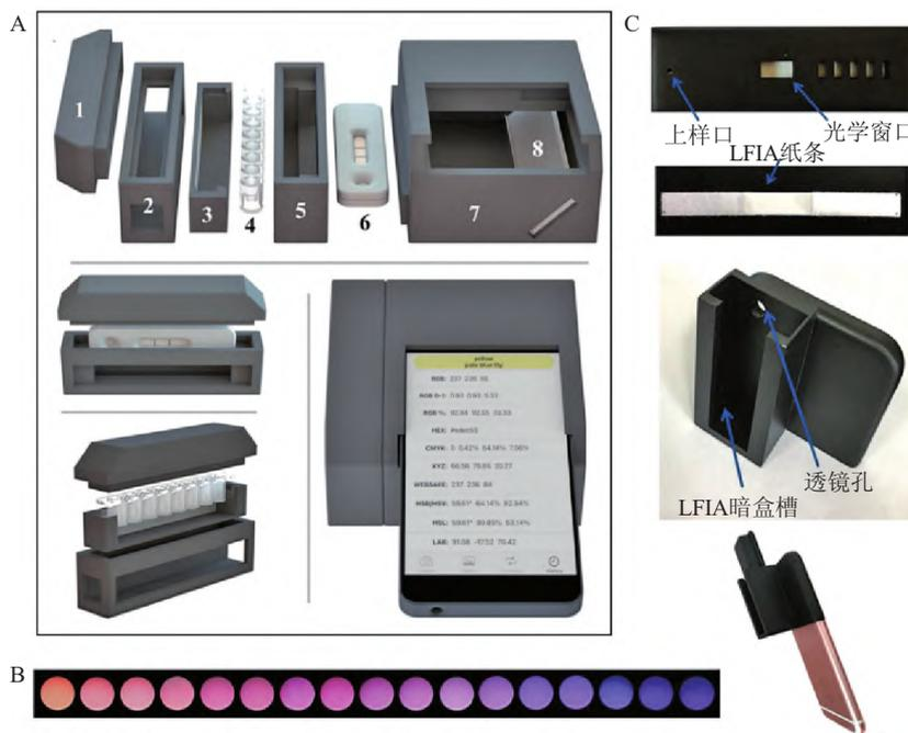
图 6 3D 打印制备的双功能光学智能手机检测设备 (A)<sup>[32]</sup>、智能手机捕获的荧光检测图像 (B)<sup>[36]</sup>及 3D 打印制备的生物发光试纸的智能手机检测配件 (C)<sup>[40]</sup>
