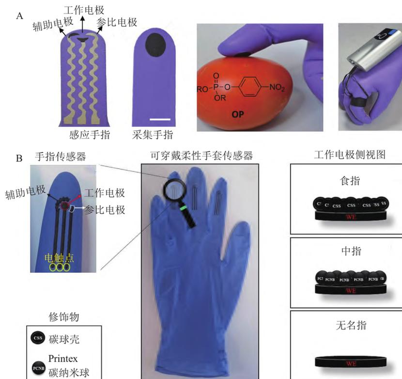
图4 基于指尖穿戴设备的有机磷(A)<sup>[23]</sup>、多菌灵、敌草隆、百草枯和杀螟硫磷(B)的电化学检测装置<sup>[24]</sup>
